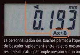
La personnalisation des touches permet à l'opérateur de basculer rapidement entre valeurs mesurées et résultats du calcul par simple pression sur un bouton.
