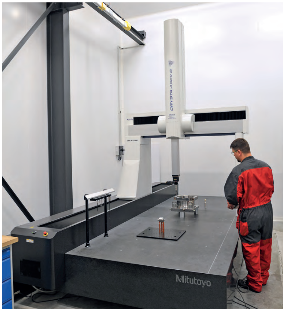
Machine de mesure tridimensionnelle CRYSTA APEX S de grande dimension (1200 x 3000 x 1000)
