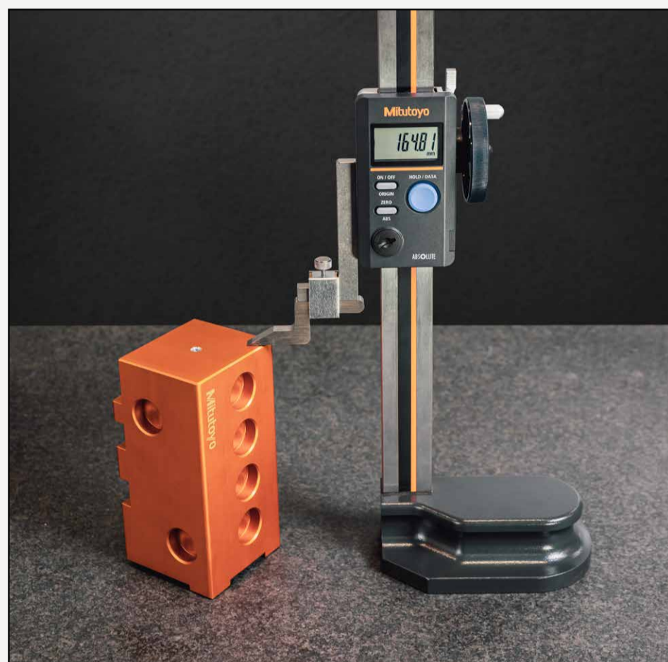
Höhenmessung mit der Messfläche der Mess- und Anreißschneide
