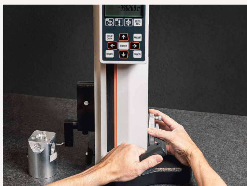
Durchmessermessung mit einem 1D-Höhenmessgerät
