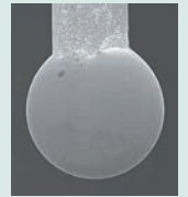
UMAP 107 ø70 µm L = 5 mm
