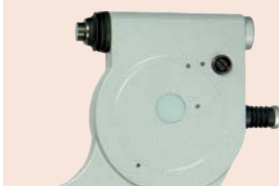
Justierschraube für Feinzeiger ± 5 µm
