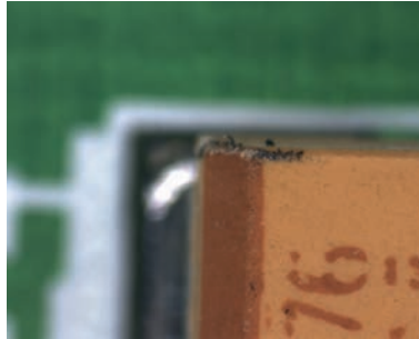
Normale Mikroskop-Betrachtung (obere Ebene) Bei einem Höhenunterschied kann nur auf die obere oder untere Ebene fokussiert werden.
