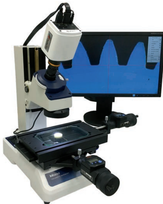
TM-1005B mit optionalem LED-Ringlicht (63AAA001), 0,37x-C-Mount-Adapter (63AAA060) und HDMI-Kamera (63AAA059)
