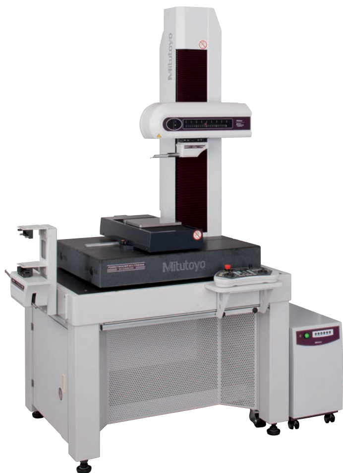
SV-C4500CNC ausgerüstet mit zwei leistungsstarken, austauschbaren Vorschubeinheiten
