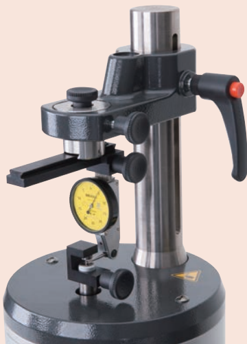
Kalibrierung von Fühlhebelmessgerät mit optionalem Zubehör
