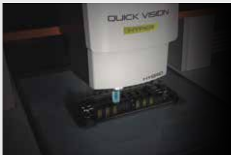
Esimerkki moottorin ohjausyksikön mittaamisesta
