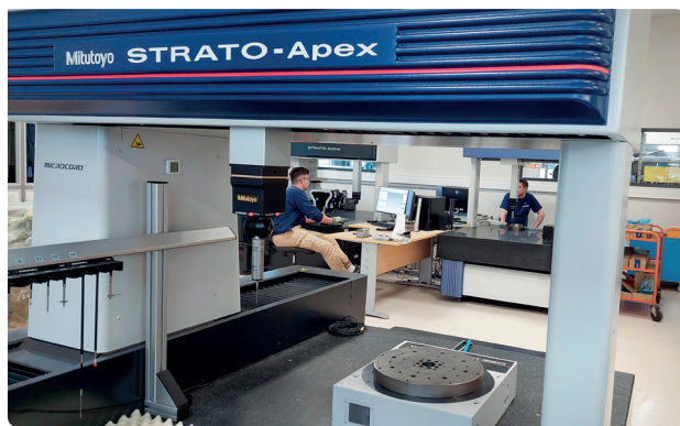
La Mitutoyo Strato-Apex avec plateau rotatif MRT dans le laboratoire de métrologie de SADEV.
