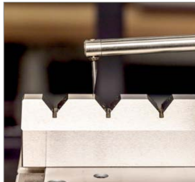
Exemple d'étalonnage de l'axe X
