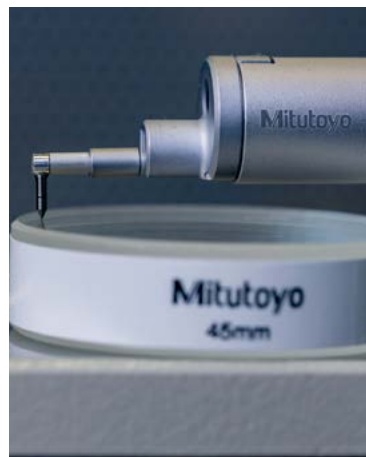
Exemple d'étalonnage du stylet
