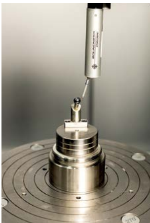
Exemple d'étalonnage du stylet
