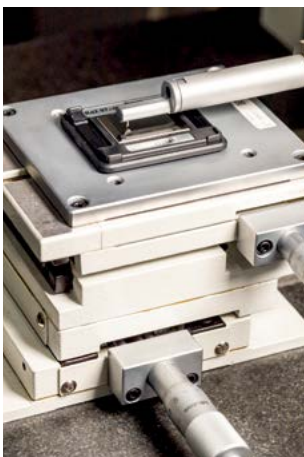
Exemple d'étalonnage du stylet
