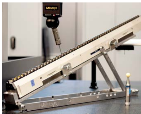
Exemple de mesure sur cale à gradin
